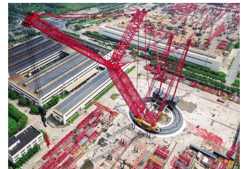
9 月 1 日，全球首台 25 万吨米环轨起重机在浙江湖州产业园正式下线。 该设备历经 7 年技术攻关，破解了华龙一号 2.0“一机两岛”施工吊装难题，采用 137 米 +66 米超长臂架组合，整机全电驱动，并搭载智能防撞墙、360° 环视、远程故障诊断、乱绳识别、人脸识别、作业行为识别等数字化系统。此次下线标志着我国超大吨位核电吊装装备打破国外技术垄断，实现关键性国产化突破。 图为 25 万吨米环轨起重机。图片来源：视觉中国
