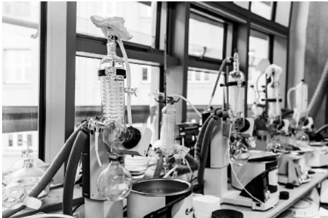
旋转蒸发仪用于从反应产物中去除化学溶剂。 图片来源:Forance/Alamy
