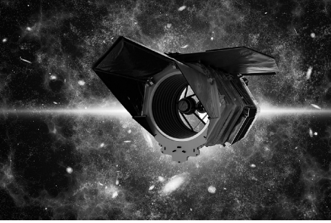
罗曼望远镜 2.4 米主镜的清晰度堪比哈勃望远镜，且观测的天区范围是后者的 100 倍。
