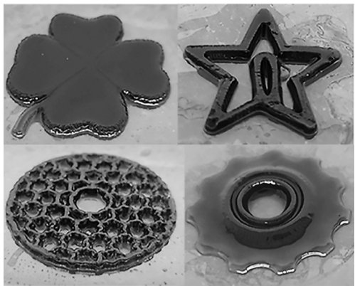
光固化3D打印不同结构的GFSP水凝胶。兰州化物所供图
