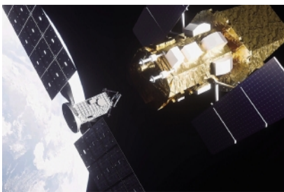
LINK(左)发射升空后,将追上雨燕(右),随后完成捕获并抬升其运行轨道。图片来源:Catalyst
