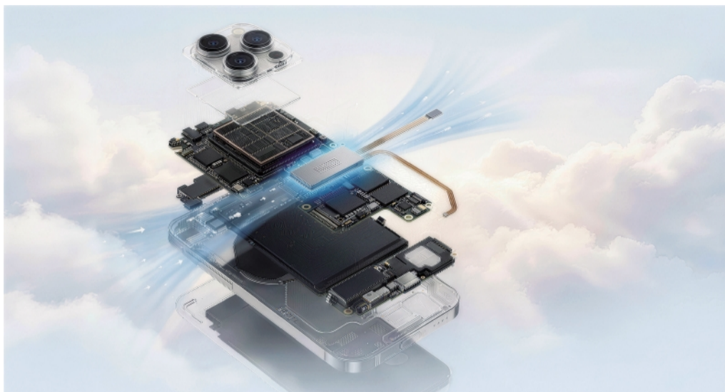
新型压电主动式散热微系统应用示意图。
