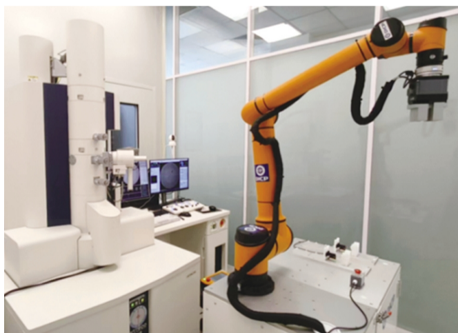
智能透射电镜系统“原眼一号”。中国科学院大连化学物理研究所供图
