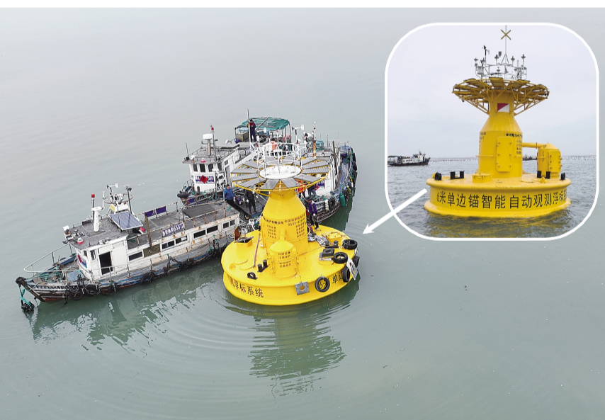
我国研制的单边锚智能自动观测浮标。中国科学院海洋研究所供图
