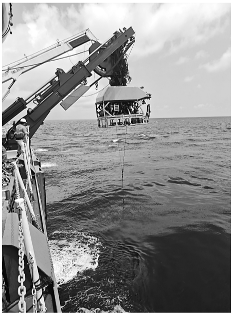
科考人员利用“海马”号无人遥控潜水器回收沉积物捕获器。
