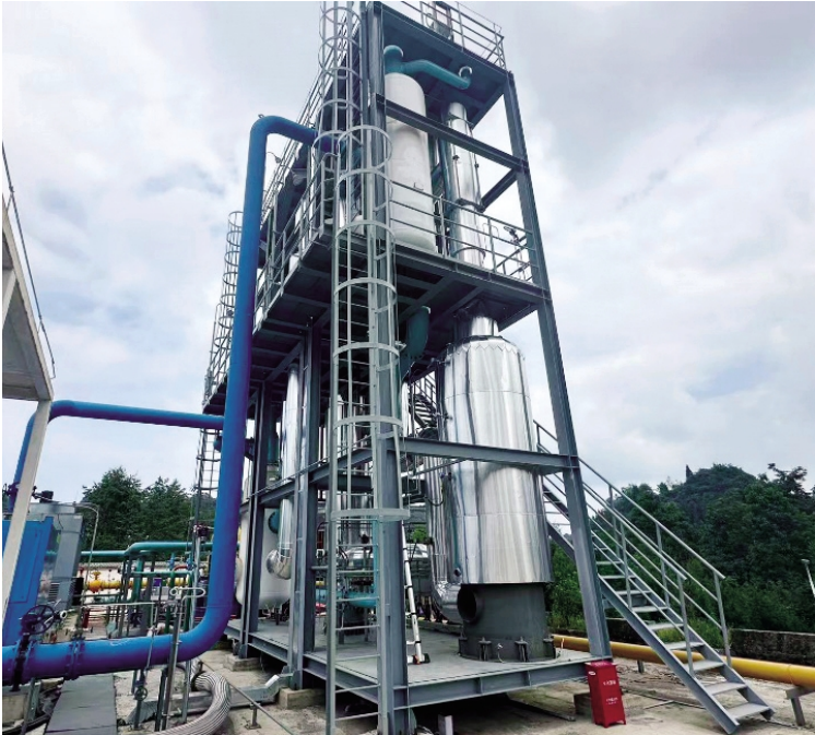
10000 立方米 / 小时煤层气催化脱氧装置。 受访者供图
