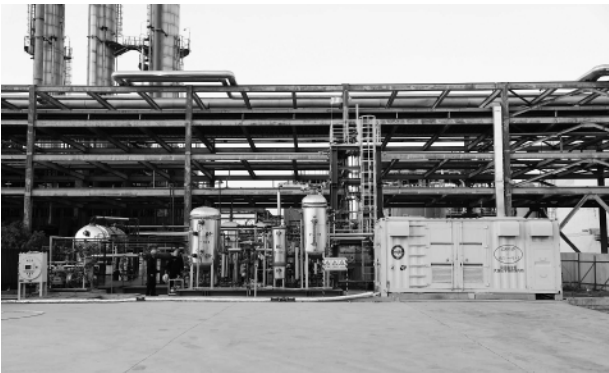
离场电催化全分解硫化氢制氢和硫磺工业示范装置。大连化物所供图
