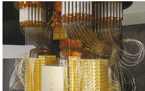
“祖冲之三号”量子计算原型机低温测试系统。
