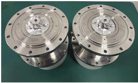
高速重载氢气透平膨胀机。 中国科学院理化技术研究所供图
