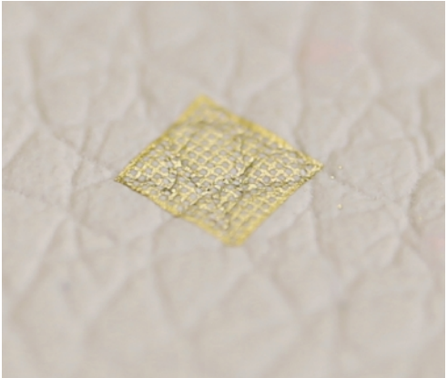
电子薄膜“温柔”贴合在目标表面的实物图片。研究团队供图
