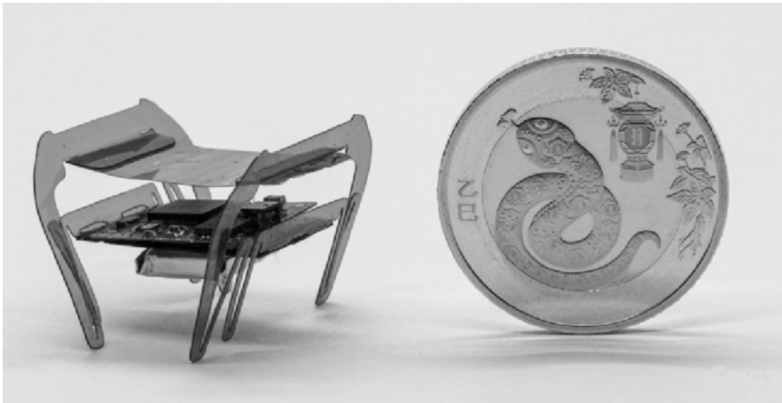
“电子蟑螂”机器人实物图，大小与一枚硬币相当。
