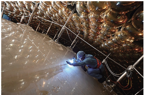
江门中微子实验中心探测器内部的有机玻璃球及光电倍增管。 中国科学院高能物理研究所供图
