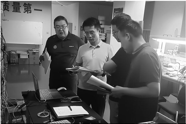
郭新兴（左二）和同事对光纤时间传递设备进行出厂测试。国家授时中心供图
