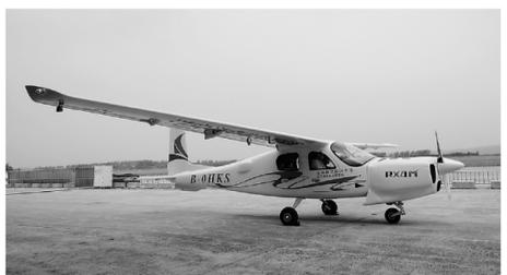
RX4M四座电电混合动力飞机原型机。大连化物所供图
