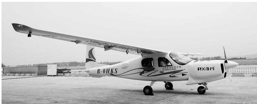
近日，RX4M四座电混合动力飞机原型机在沈阳法库财湖机场成功首飞。该飞机由辽宁通用航空研究院设计制造，采用电混合动力系统，搭载了中国科学院大连化学物理研究所研究员邵志刚、副研究员谢峰团队研制的氢燃料电池。该飞机在起飞和爬升时，由燃料电池和锂电池共同供电，巡航阶段则由燃料电池单独供电并为锂电池组充电。其最大起飞重量为1400公斤，有效载荷320公斤，最大航程400公里，续航时间2小时。
