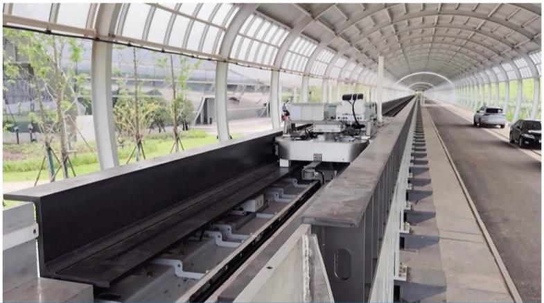
近日，在湖北东湖实验室，科研人员通过悬浮支撑和电磁推进的方式，成功在1000米距离内将1.1吨重的试验车加速至650米/小时。
