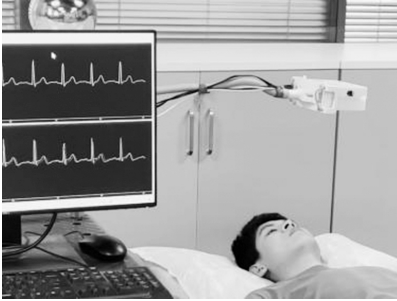
毫米波非接触心电图实时监测感知系统。 受访者供图
