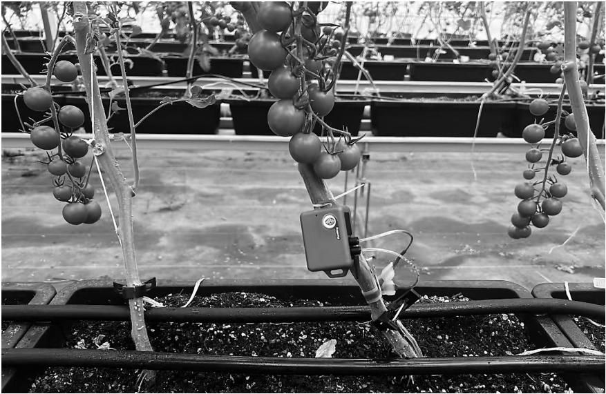
安装在番茄成株上测量茎直径的 PlantRing。
