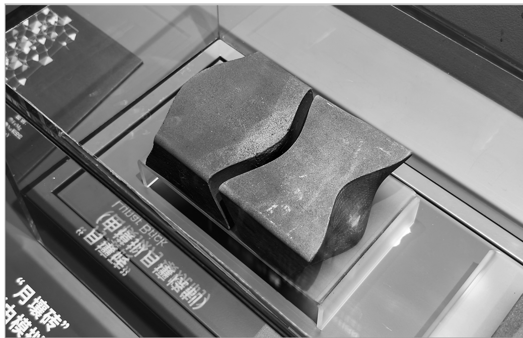
2月12日，北京天文馆，“问月——中国探月工程嫦娥五号月球样品展”展出我国航天成就。展览中，涵盖月壤各种形态的共计0.6克嫦娥五号月球样品与公众见面。 图为用模拟月壤烧制的月壤砖。图片来源：视觉中国
