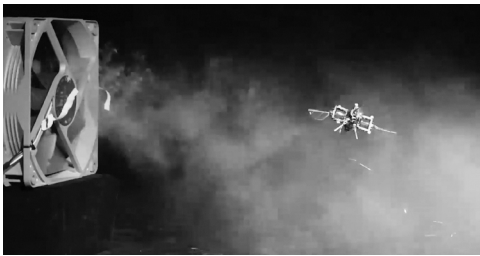
得益于高效的控制器,这个昆虫大小的机器人可以在短短几秒钟内完成急转弯和多次空翻。 图片来源:《科学进展》
