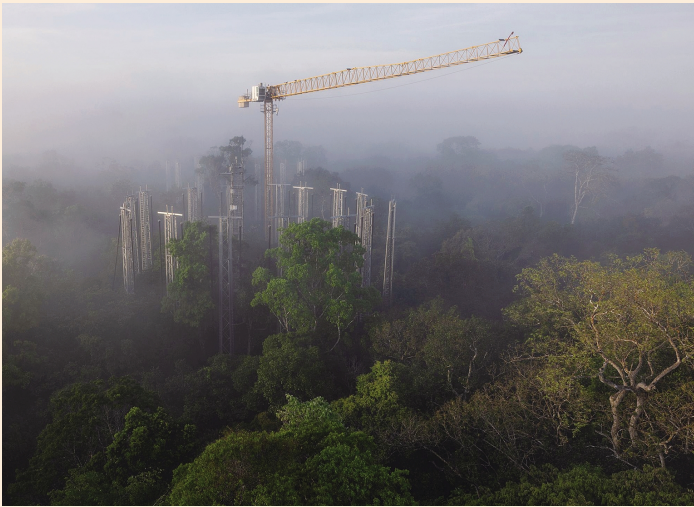
►森林时光机。科学家在巴西贝伦附近建造了一台“时光机”，通过向森林冠层注入二氧化碳来模拟未来大气环境。该项目旨在研究生物群落如何适应气候变化。 图片来源: Lalo de Almeida/Panos Pictures
