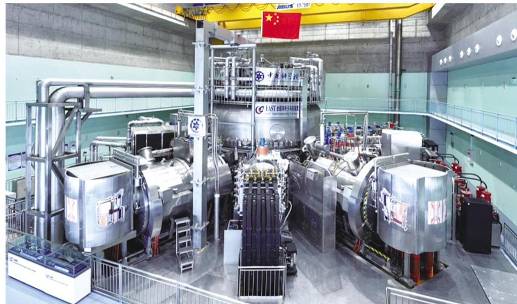
世界首台全超导托卡马克核聚变实验装置 EAST。
