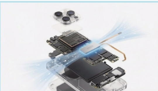
黎冰团队研发的MEMS固态散热芯片为端侧人工智能(AI)大模型芯片散热赋能。
