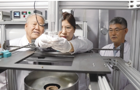
研究人员在超导磁力仪中放置月壤样品。 地质地球所供图
