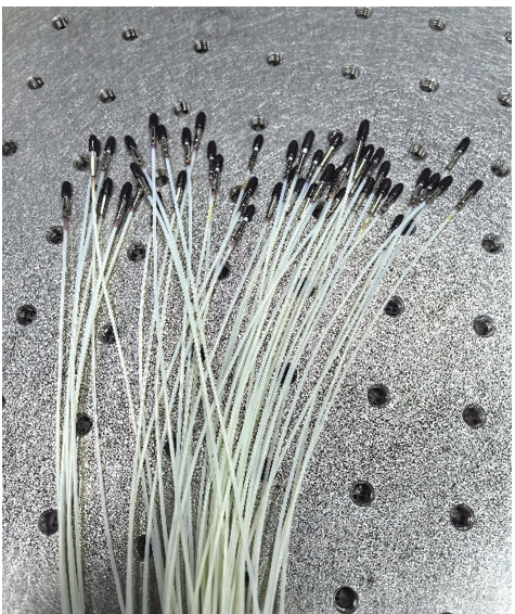
加了保护套管的国产化光纤样品。 国家天文台供图
