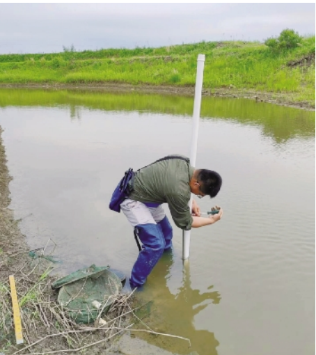
水位计安装。 东北地理所供图
