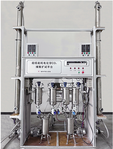
电化学反应原理样机。 研究团队供图
