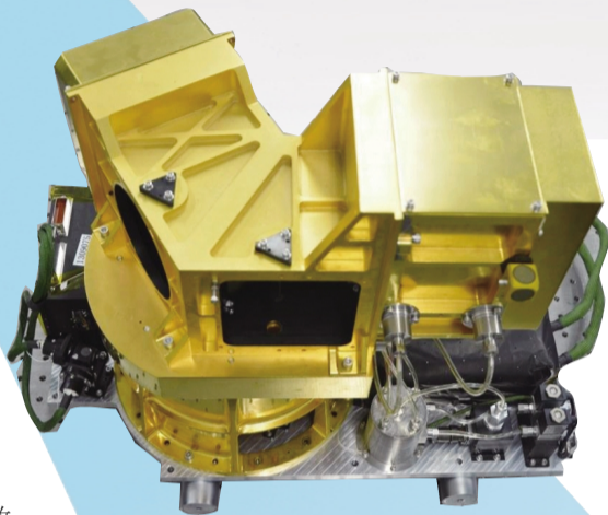
干涉式大气垂直探测仪核心——低温红外干涉仪。
