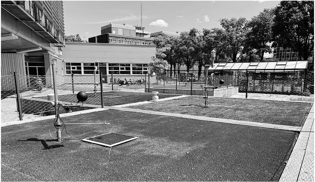
在荷兰阿姆斯特丹的一个试验场,科学家对自冷草坪和普通人造草坪进行对比测试。 图片来源:Joris Voeten
