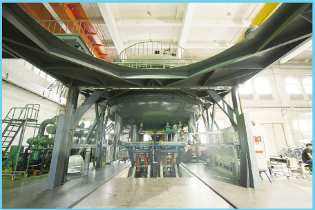
4 米高温真空烧结炉。
