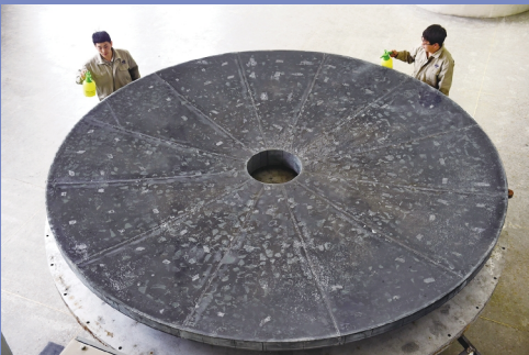
反应烧结后的 4 米碳化硅反射镜坯。
