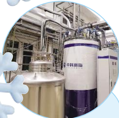
我国首套出口国际的200瓦液氦温区制冷机。
