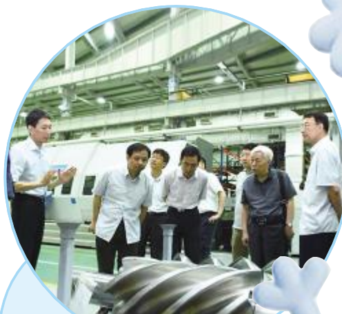
用于2500瓦低温系统的液氢螺杆压缩机测试验收。
