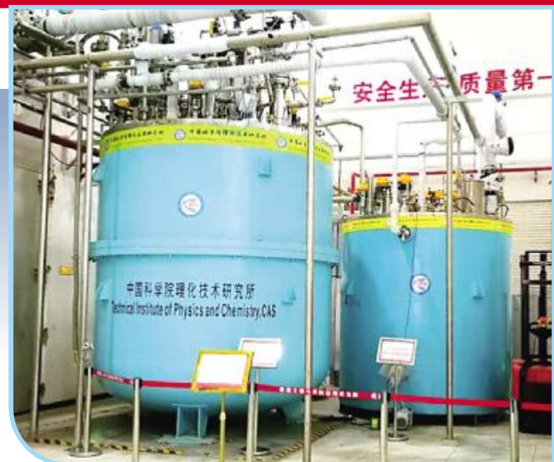
-269℃温度下冷量为2500瓦的千瓦级液氢制冷机冷箱(左)和-271℃温度下冷量为500瓦的百瓦级超流氦制冷机冷箱(右)。
