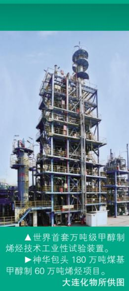
▲世界首套万吨级甲醇制烯烃技术工业性试验装置。
