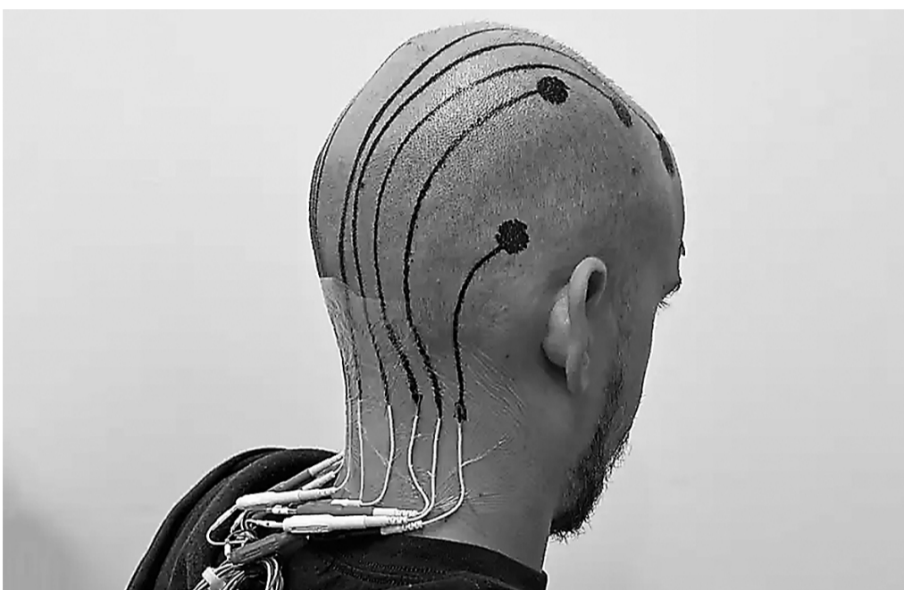
印在头皮上的电子纹身可以检测大脑电活动,并将信号传输到记录设备。图片来源:鲁南珠
