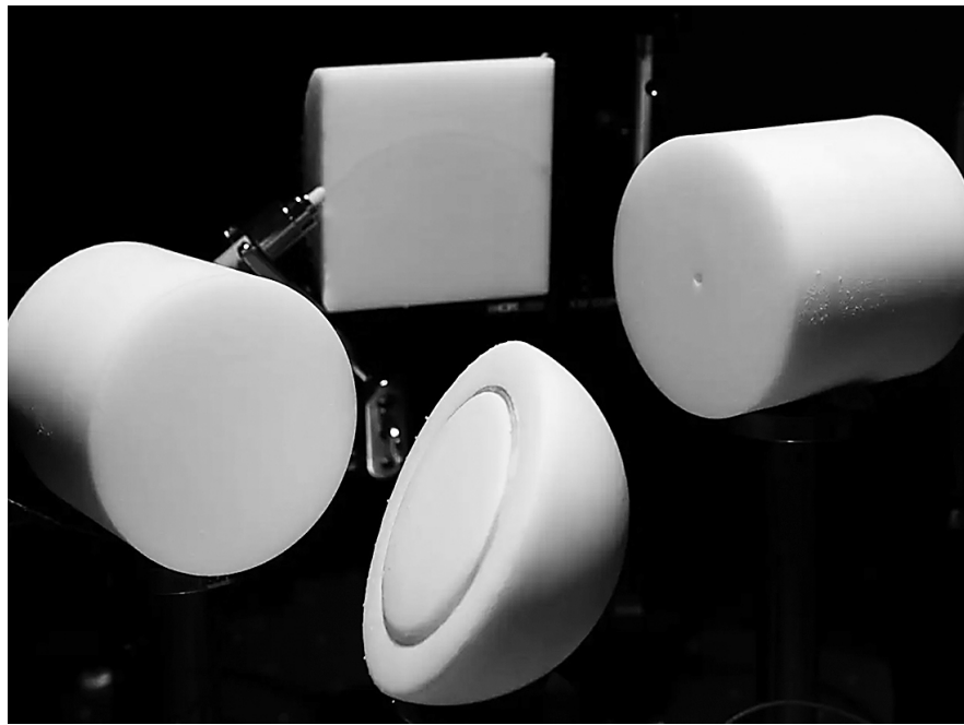
3D打印的白色块状材料,内有弯曲通道,可以引导光散射。图片来源:格拉斯哥大学
