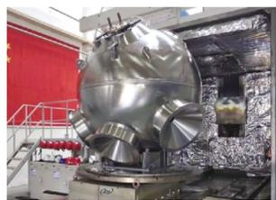
“奋斗者”号载人舱完成电子束焊接。中国科学院金属研究所供图
