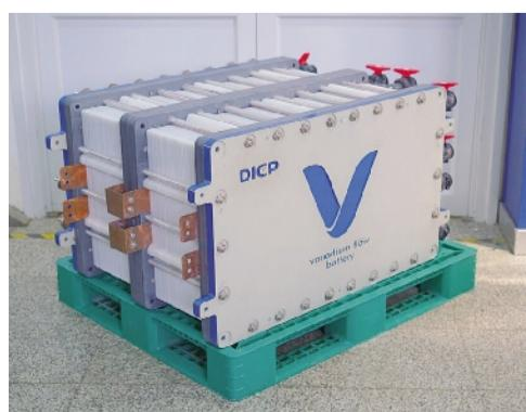
70千瓦级高功率密度全钒液流电池单体电堆。
