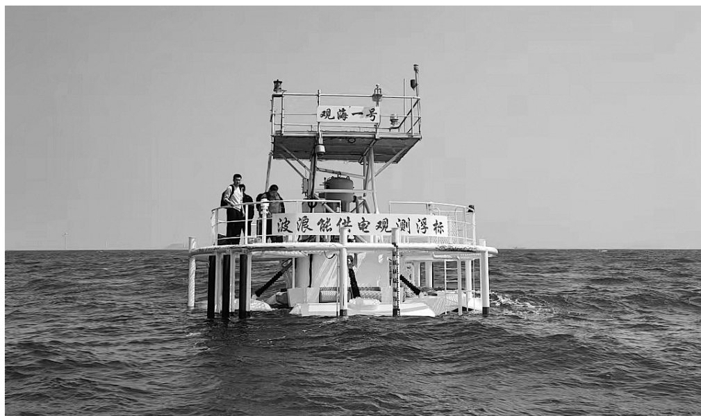
“观海一号”波浪能原位供电观测浮标。 广州能源所供图
