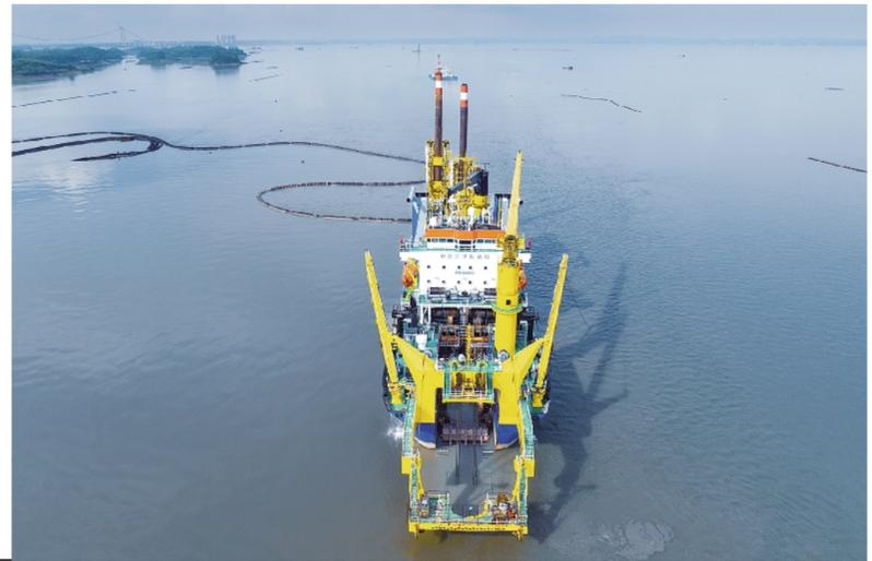
国之重器“天鲸号”被誉为造岛神器,具备挖得快、排得远的特点,每小时吹填造地 4500 立方米,相当于填造一个足球场。“天鲸号”还具有疏浚造填效率高、速度快、质量优的特点,结合平陆运河实际土质,日均吹填的土石方量可达 2.5 万立方米。平陆运河是西部陆海新通道的骨干工程,全长 134.2 公里。图片来源:视觉中国
