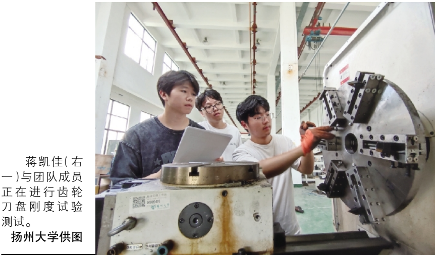
蒋凯佳(右一)与团队成员正在进行齿轮刀盘刚度试验测试。扬州大学供图
