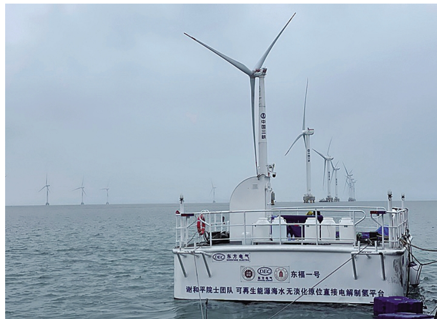
可再生能源海水无淡化原位直接电解制氢平台。受访者供图
