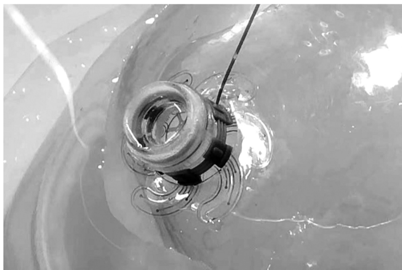
软体机器人柔软的腿上嵌满了监测大脑活动的传感器。图片来源：Sukho Song
