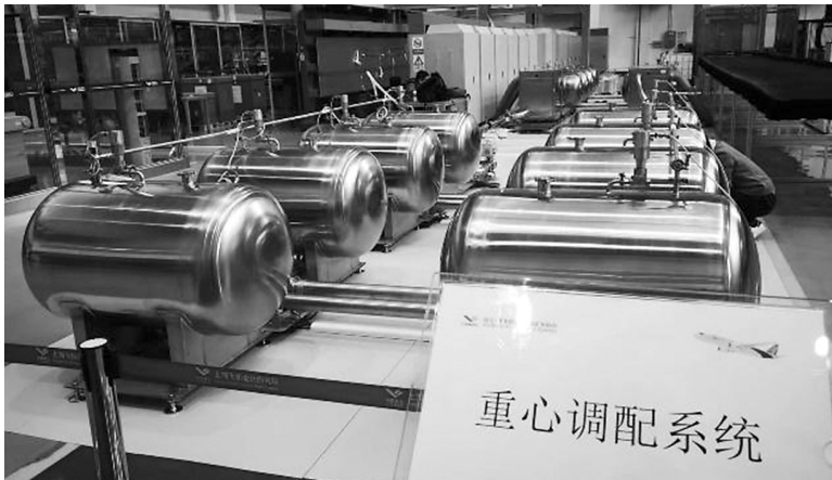
C919 大型客机重心调配系统地面试验。
