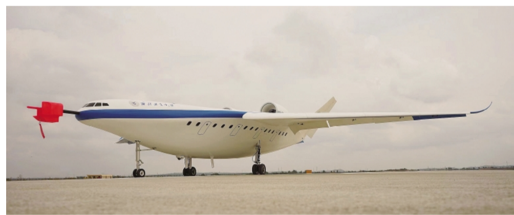
翼身融合大型客机缩比试验机试飞现场。
