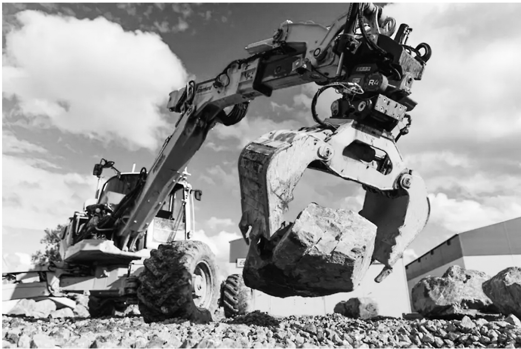
一辆机器人建筑车在挑选并扫描每块石头，以确定它们在石墙中的位置。 图片来源:Marc Schneider
