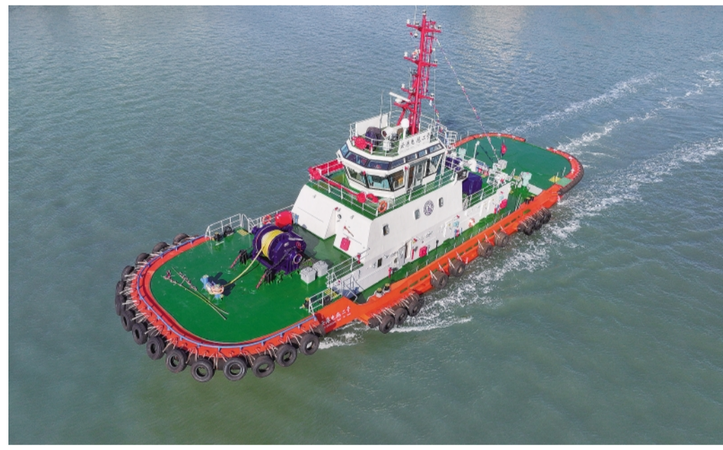
11 月 20 日,全球马力最大的纯电拖轮“云港拖二”在江苏连云港交付使用。该拖轮设计总长 39 米、型宽 10.5 米、型深 4.8 米,最大航速 13.0 节,最大拖力达 65 吨,是目前全球范围内马力最大、电池装机容量最大的纯电拖轮。据了解,5400 马力的“云港拖二”纯电拖轮采用磷酸铁锂电池组作为动力源,实现大气污染物的零排放。图片来源:视觉中国
