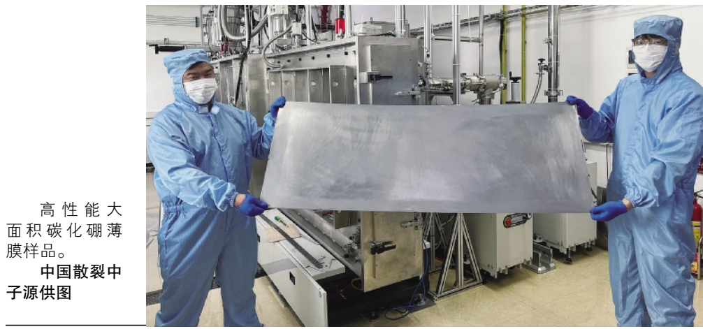
高性能大面积碳化硼薄膜样品。
